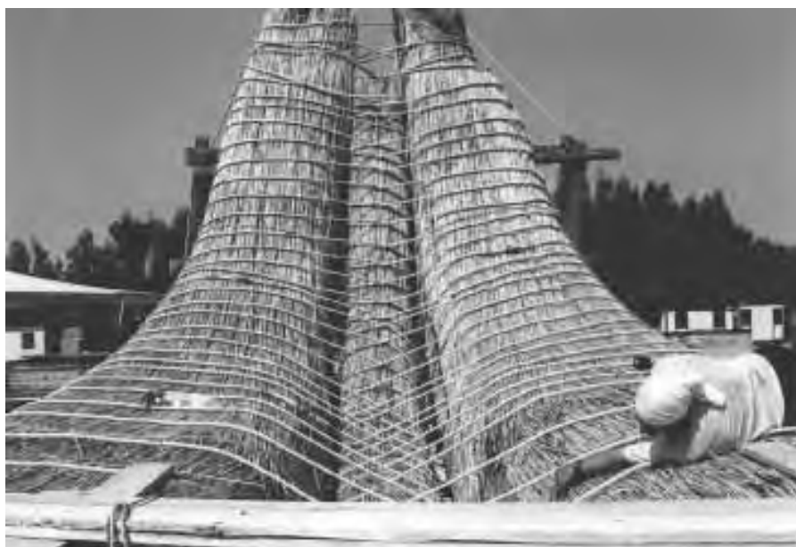
Abb. 11a und b: Das Verzurren der Spirallasching. Mit der vereinten Kraft aller Männer und Frauen wurden die beiden Spiraltäue fest verschnürt. Es entstand ein massives Doppelpfandboot (siehe unten).
