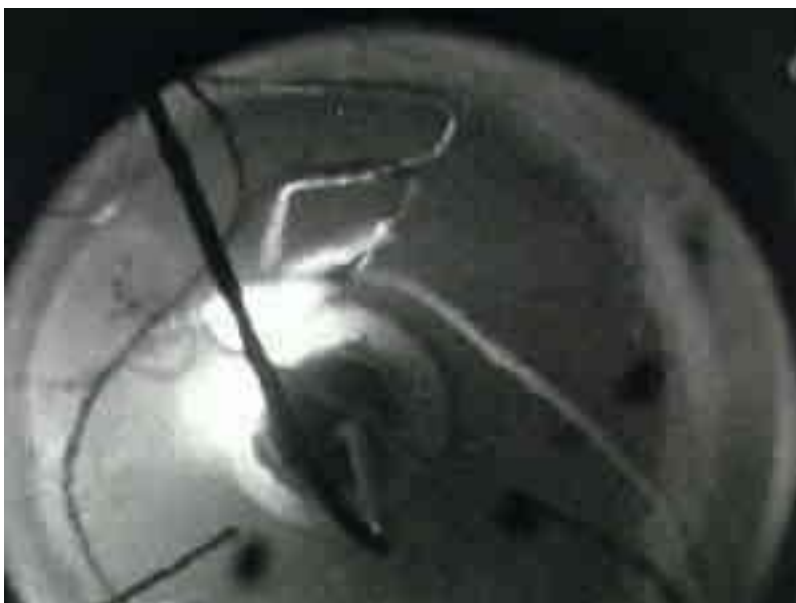
Teflon-Isolation verbrennt unter irdischen Schwerkraftbedingungen und reiner Sauerstoffatmosphäre (wie sie in den APOLLO-Kapseln herrschte) (NASA-Foto)
