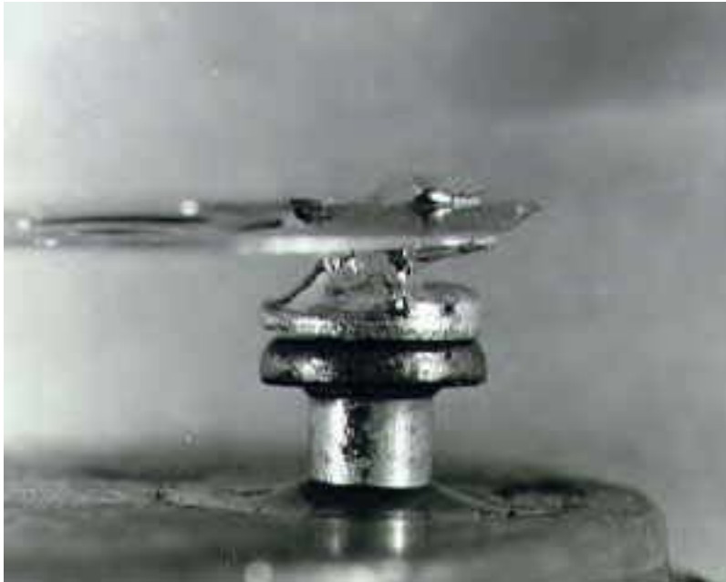
Lt. NASA das durchgebrannte Ventil des Sauerstoffbehälters von APOLLO 13.
