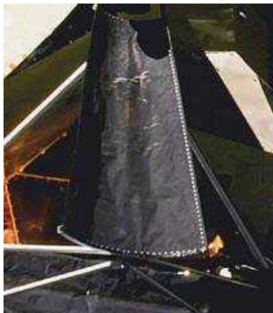
Ein zerknittertes Abgas-Ableitblech von der APOLLO-17-Fähre (Ausschnitt aus Bild-Nr. as17-134-20463)
