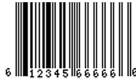
Bild 2: Von einem Standard-UPC-Generator erzeugter ‚bar-code‘, der die Zahl 123456666666 darstellt und die Orientierungs-codes jeweils als Sechser erkennen lässt.
