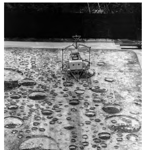
Landefähren-Simulator am Seil auf nachgestellter Mondoberfläche unter dem Kran. Anfangs sah sie noch etwas futuristisch aus, wurde später jedoch mehr den irdischen Gegebenheiten angepasst, wie auch die APOLLO-Fotos von der „Mondoberfläche“ recht irdisch aussehende Oberflächen-Merkmale zeigen (NASA-Bildnummer 04dcb440)
