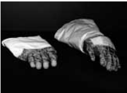
Die Handschuhe eines APOLLO-Raumanzuges. Links der Innenhandschuh, rechts der Überhandschuh. Dass man damit keine feinmotorischen Arbeiten verrichten konnte, liegt wohl auf der Hand.
