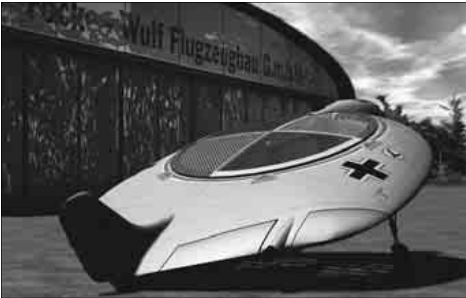
Abb. 3: Der Focke-Wulf-Senkrechtstarter war eine Kombination zwischen einem herkömmlichen Flugzeug und einer Flugscheibe. Er besaß eine annähernd runde Form, im Zentrum rotierten waagrecht zwei gegenläufige Propellereinheiten (Rekonstruktionszeichnung).
