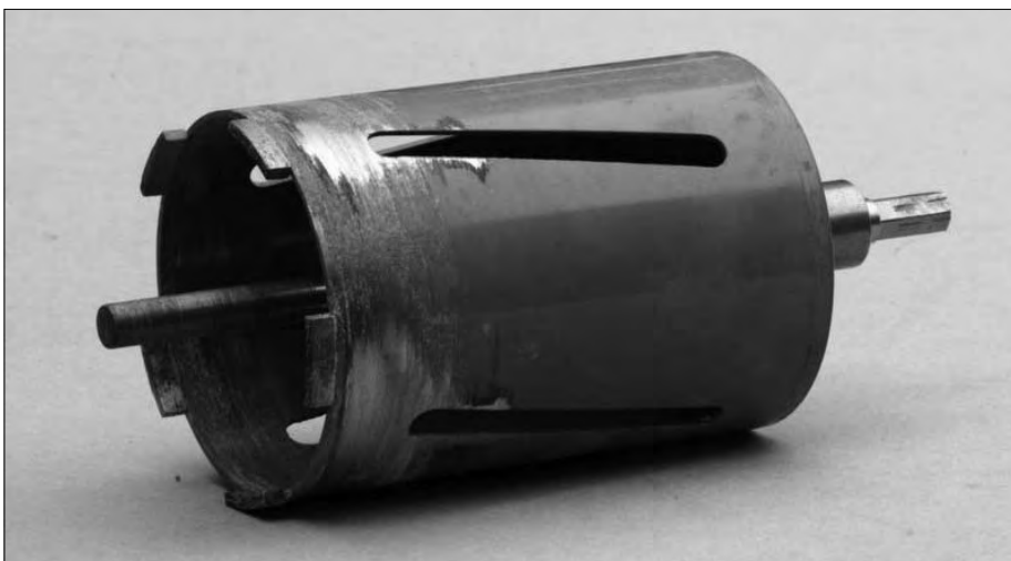
Ein Diamant-bestückter Bohrkopf für Kernbohrungen aus unserer Zeit.
