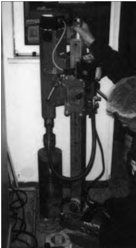
Modernes Bohrgerät mit Widea-Krone
