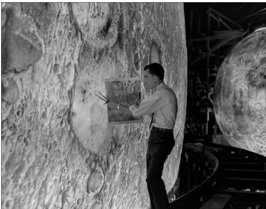
Letzte Arbeiten an einem der rund elf Meter durchmessenden Mondmodelle im NASA-Langley Research Center, vor denen dann die Apollo-Modelle gefilmt wurden, als würden sie um den echten Mond kreisen.
