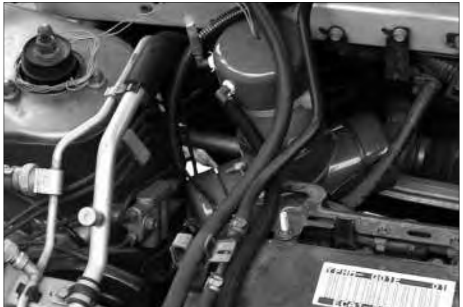
Bild 3: Im Motorraum eingebaute Browngaszelle.
