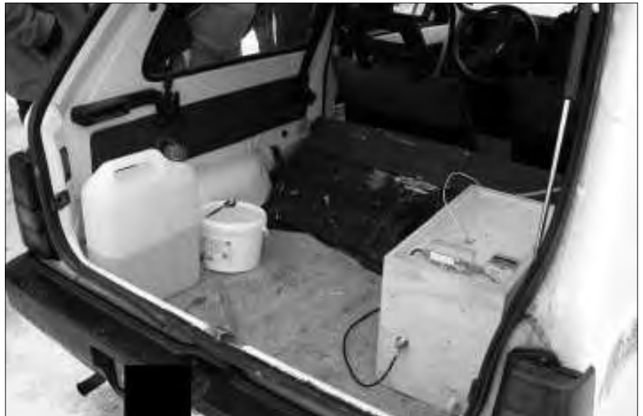
Bild 4: Browngaszelle im Kofferraum.
