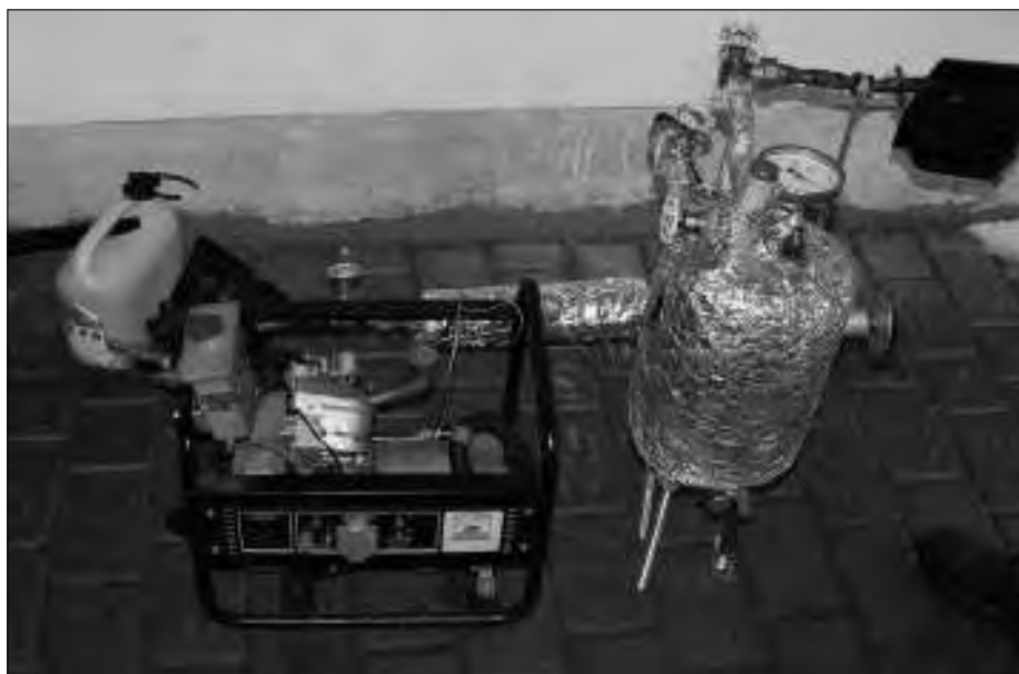
Bild 8: Notstromaggregat mit GEET-Vorrichtung.
