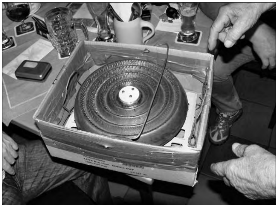
Bild 4: Selbstständig weiterlaufende Scheibe. Diese Scheibe wird mit einem Motor in Drehung versetzt. Nach Abstellen des Motors soll die Scheibe ohne Antrieb weiterlaufen. Voraussetzung ist jedoch, dass die Scheibe unwuchtfrei und völlig waagrecht ausgerichtet ist. Das war während des Vortrages nicht zu realisieren, sodass wir über die Funktion kein Urteil fällen können.
