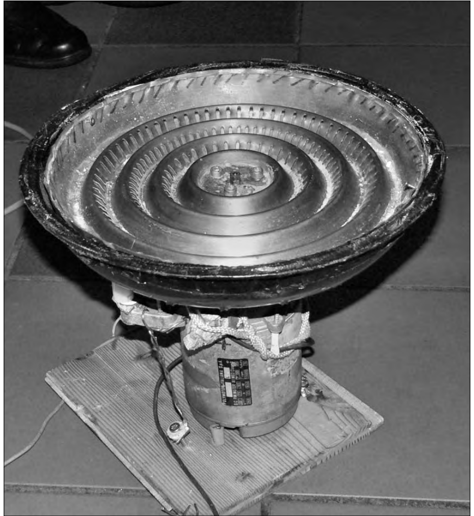
Bild 3: Scheibe nach dem Schauburger-Prinzip zur Klimatisierung eines Raumes. Die Scheibe wird mit einem Gleichstrommotor gedreht und erzeugt dabei einen warmen Luftstrom. Der Gleichstrommotor wird über einen Akku mit Solarenergie betrieben.
