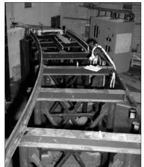
Die Schienen, auf denen Kameras gefahren werden können (Bild-Nr. EL-2002-00399).
