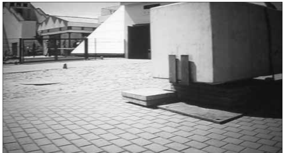
Vor dem Experiment: Der Betonblock liegt auf ein paar Platten.
