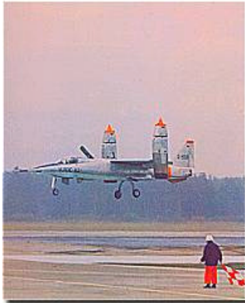
Abb. 29: Die VJ 101 C, von MBB in Deutschland entwickelter erster senkrecht startender Überschalljäger der Welt. Einst als Nachfolger des Starfighters vorgesehen und später zur VAK 191 (Erstflug am 10.9.1971) weiterentwickelt. 499
