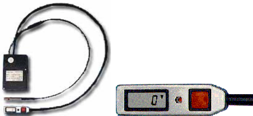
Abb. 7: Das Cypres Automatic Activation Device (AAD). Das Gerät wird tief im Fallschirmpaket eingebracht und nur das Display (rechts) ist bei manchen Fallschirmen am Gurtzeug zu sehen. Beim Einschalten zeigt ein LCD-Display die Voltzahl der Batterie an, so dass ein Funktionieren sichergestellt ist. Das Gerät erkennt über die Fallgeschwindigkeit, ob ein Springer noch fällt und ob der Fallschirm aktiviert wurde. Es löst bei einer Höhe von ca. 225 m über Grund automatisch den Reservefallschirm aus. Sowohl zum Einschalten wie auch zum Ausschalten ist der Taster viermal zu drücken.
