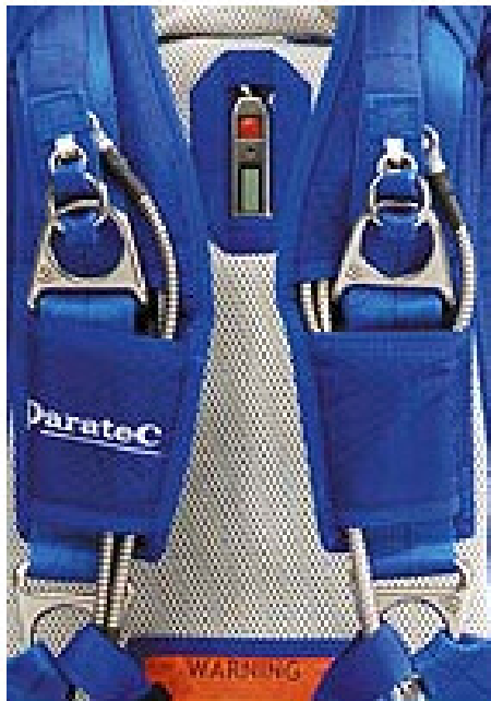
Abb. 6: Ein moderner Paratec-Schirm. Moderne Schirme können Springer aktiv mit mehrfacher Sicherheit schützen: 1) Muss ein Springer den Hauptschirm abtrennen, kann er einen Notfallschirm betätigen. 2) Betätigt ein Springer den Schirm nicht, sorgt ein AAD-System von Cypres für rechtzeitige Auslösung. Es ist in der Mitte senkrecht in den Fallschirm integriert. Bei einem Tandemschirm ist es horizontal befestigt. 73
