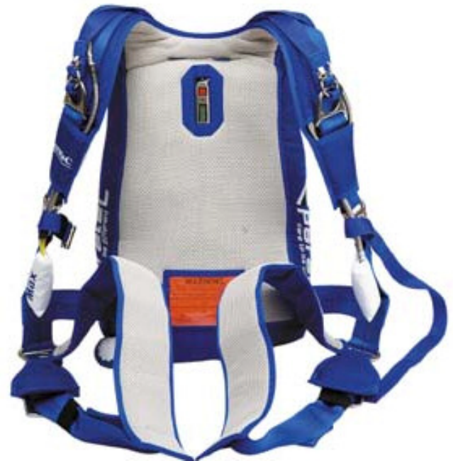
Abb. 6: Ein moderner Paratec-Schirm. Moderne Schirme können Springer aktiv mit mehrfacher Sicherheit schützen: 1) Muss ein Springer den Hauptschirm abtrennen, kann er einen Notfallschirm betätigen. 2) Betätigt ein Springer den Schirm nicht, sorgt ein AAD-System von Cypres für rechtzeitige Auslösung. Es ist in der Mitte senkrecht in den Fallschirm integriert. Bei einem Tandemschirm ist es horizontal befestigt. 73
