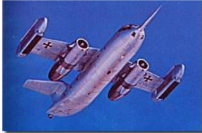
Abb. 30: Die DO 31 E, ein 1967 von Dornier in Deutschland entwickeltes senkrecht startendes Transportflugzeug.
