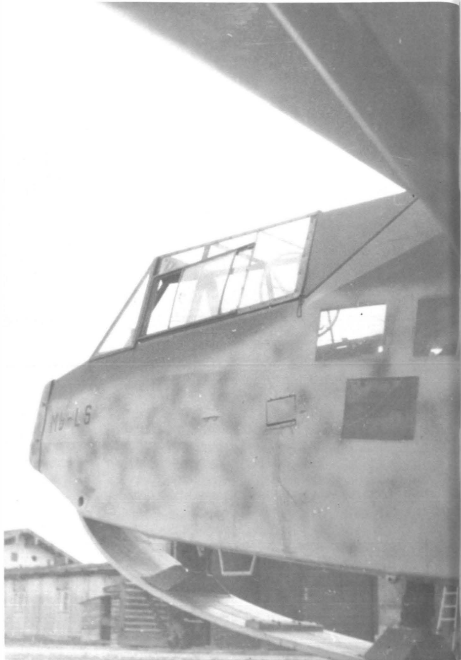
Rumpfbug einer DFS 230 C-1 mit verkleideter Raketenbremsanlage im vorderen Rumpfteil.
