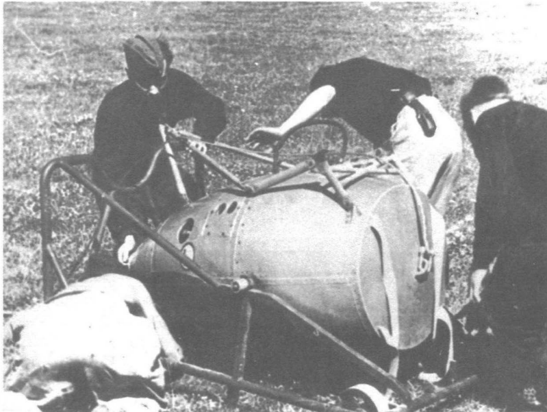
Starthilfe 109-500 A1 mit einer Schubleistung von 500 kp bei 30 s Brenndauer vor einer Ju 88 A-4. (BA)
