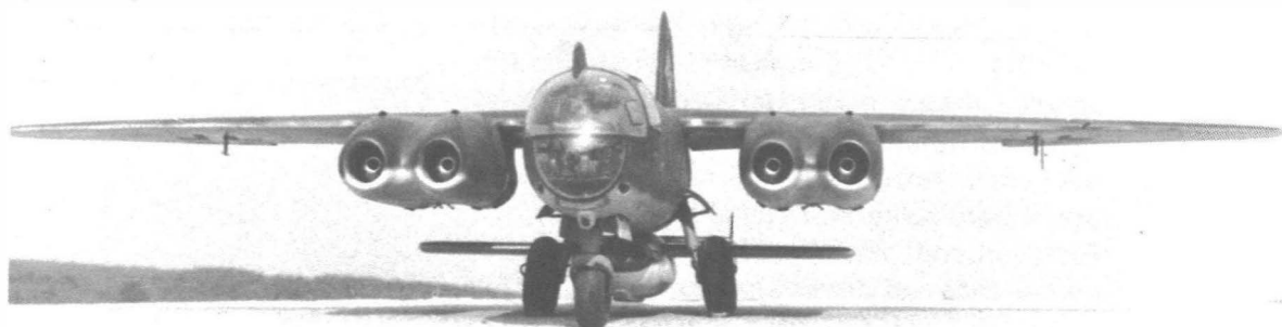
Modellaufnahmen der Ar 234 C-3 mit unter- gehängtem Kleinstjä- ger Ar E 381.
