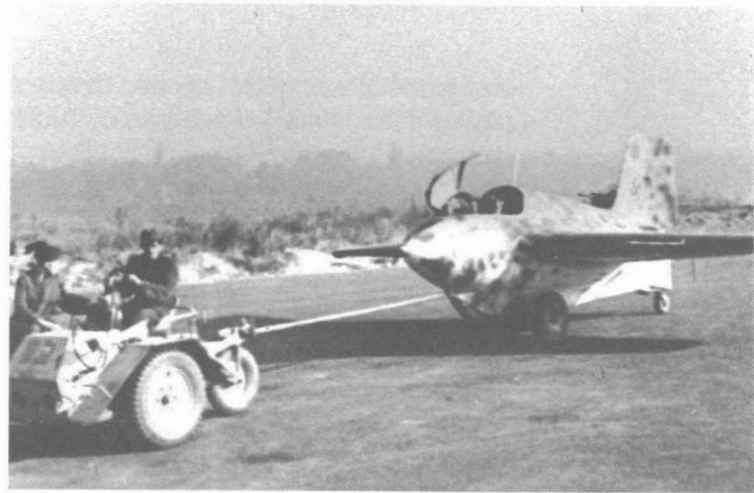
Der speziell für die Me 163 entwickelte Scheu-Schlepper zieht die auf das Rollwerk gesetzte Einsatzmaschine.
