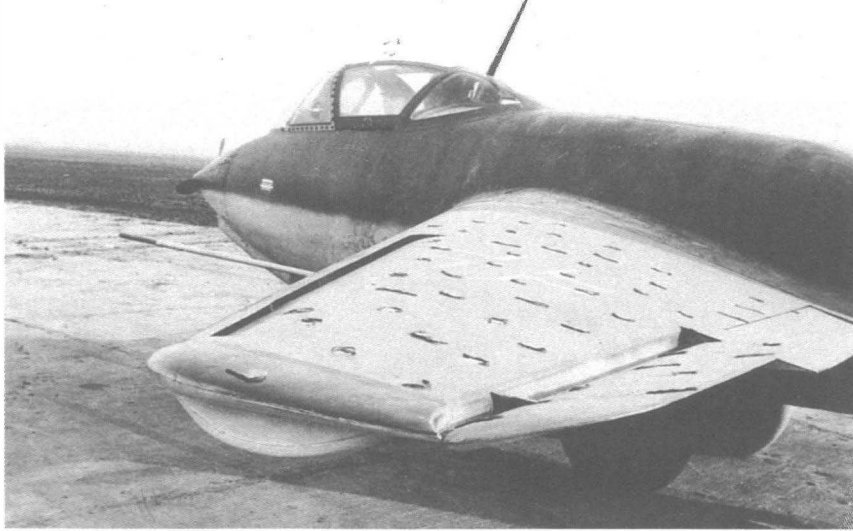
Zur Untersuchung der Strömungsverhältnisse am Tragflügel dienten zahlreiche aufgeklebte Wollfäden.
