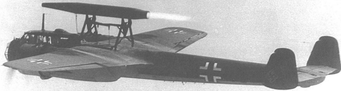
Flugerprobung mit einem auf die Do 17 Z-2 aufgesetzten Lorin-Triebwerks, Frühjahr 1942.
