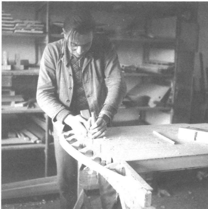
Bearbeitung der Tragflächen-Endscheibe einer BP 20.
