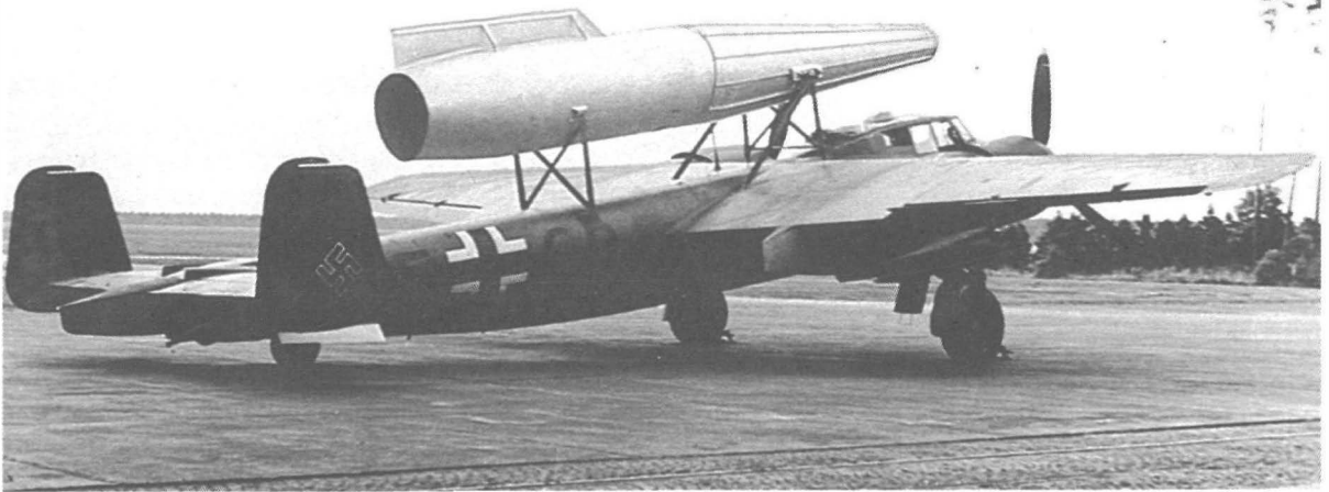
Do 217 E-2 mit aufgebautem 20000 PS Mustertriebwerk.
