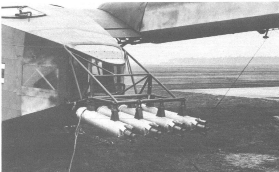
Heckgerüst mit vier Feststoffraketen 109-502 bei der Go 242.
