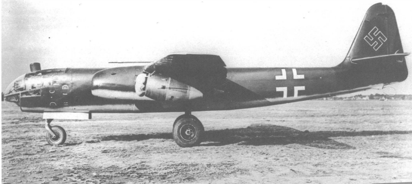
Ar 234 V 17 (WerkNr. 130027) mit zwei HWK-Starthilfen.
