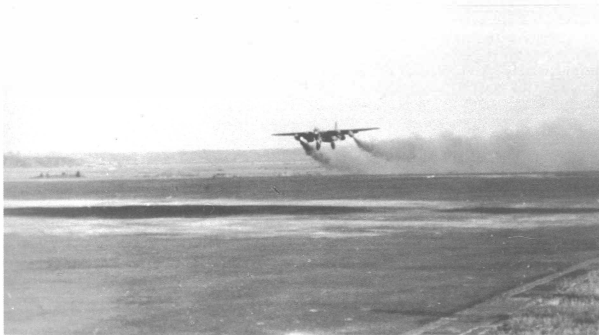
Ar 234 V 17 (WerkNr. 130027) mit zwei HWK-Starthilfen.
