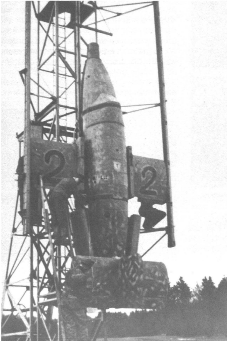
Startvorbereitung bei der BP 20 M22 für die Triebwerks- und Brems- schirmerprobung.
