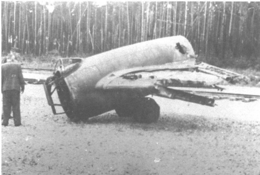
Das in Dessau 1945 von amerikanischen Truppen gesprengte mittlere Rumpsegment der Me 263 V2.
