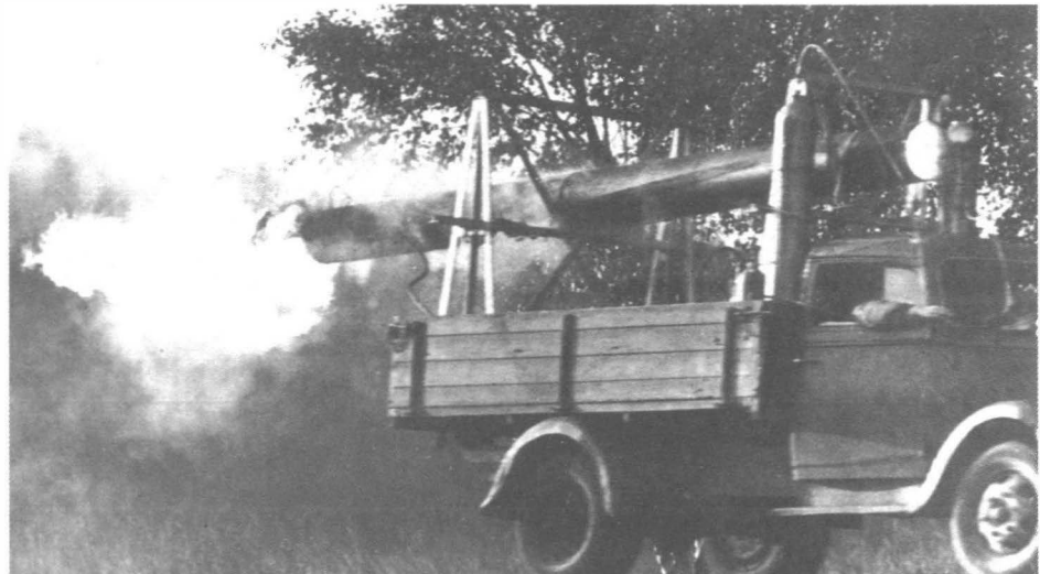
Erprobung des Sängerschen Lorin-Triebwerks im Frühjahr 1941.
