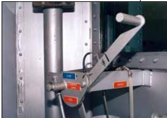
Abb. 101 (oben): Hebel zur Freigabe des Gasgranulats.
