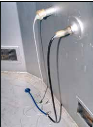
Abb. 112: Im Innern der Gaskammer, wo die Stethoskopleitung und andere Messkabel eintreten. Sie sind mit Vaseline bedeckt, um Lecks aufzuspüren. Rechts unten: Frischluftöffnung an der Wand nahe dem Fußboden.
