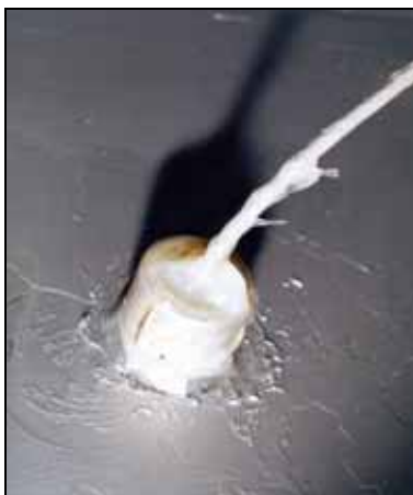
Abb. 113: Nahaufnahme des Eintrittspunktes eines Messkabels in das Innere der Kammer, bedeckt mit Vaseline.
